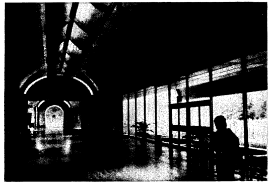
(写真16) 美術館エントランス。サイクロイド曲線の天井の天頂部と、妻側スリットから自然光を導入している。
